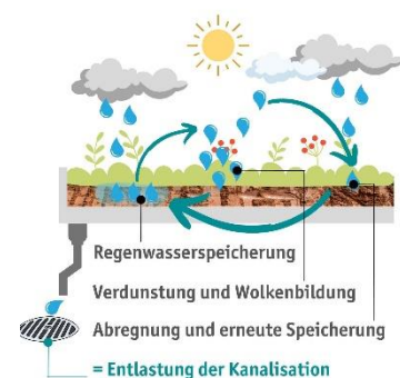
Dachbegrünung unterstützt den natürlichen Wasserkreislauf
