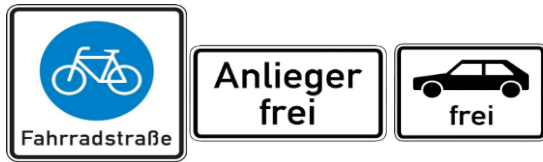
Abbildung 3: Beschilderungs- / Markierungslösung (innerörtlicher) Fahrradstraßen
